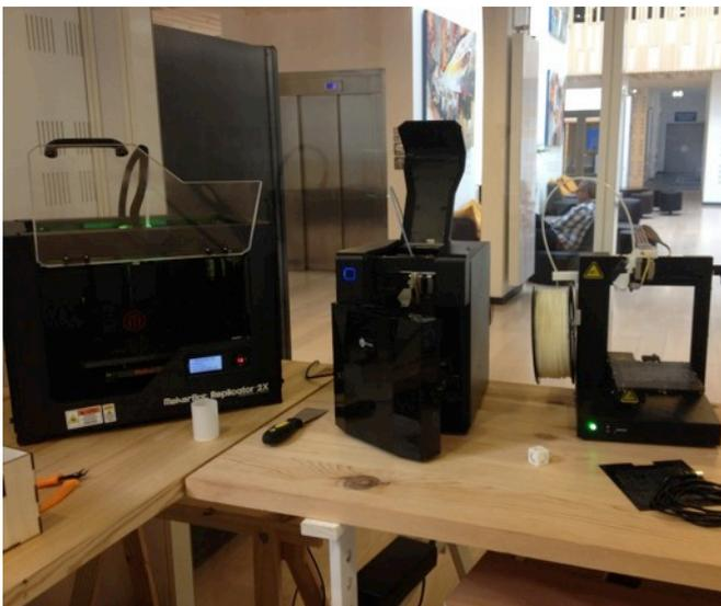
Une imprimante 3D est une machine utilisant la technique de fabrication additive permettant de fabriquer, couche par couche, par ajout de matière, un objet physique à partir d'un objet numérique.
